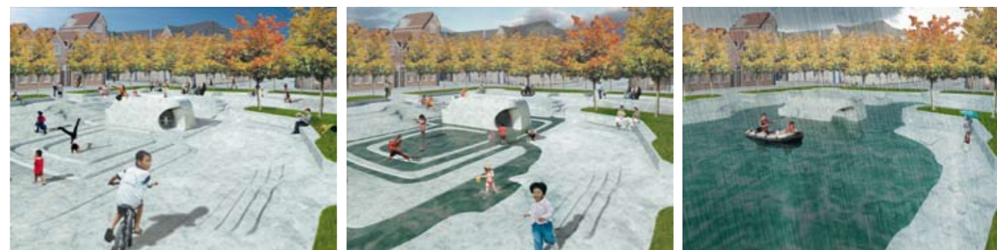
Ontwerp Bloemhofplein, weergave bij verschillende weersomstandigheden. Waterpleinen zijn een middel om, om te gaan met hevige regenval.
