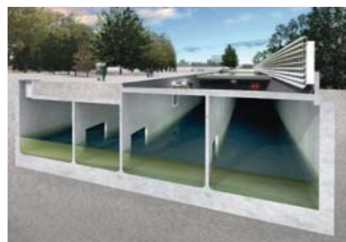
Waterberging Museumgarage. Met het motto: Water graven waar het kan, innovatief als het moet, zoekt Rotterdam naar nieuwe oplossingen voor de wateroverlast van piekbuien. Een middel is het tijdelijk ondergronds bergen van regenwater onder de Museumgarage
